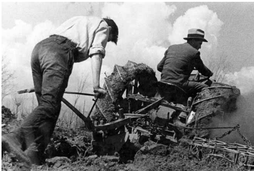
Buja 1938: il trattore è della prima generazione, con ruote in ferro e senza sollevatore. Si poteva porre l'aratro composto (con carrello) "a traino", oppure, come in questo caso, applicarlo direttamente al trattore dopo aver apportato delle modifiche artigianali. Notare l'erpice ( grape ) che, collocata di fianco, effettuava l'erpatura del terreno contemporaneamente all'aratura. Fotografia di Tarcisio Baldassi.
