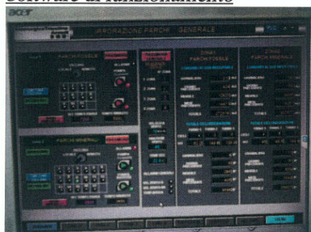
Foto 6. Schermata del software utilizzato per il controllo degli irroratori dei parchi.
