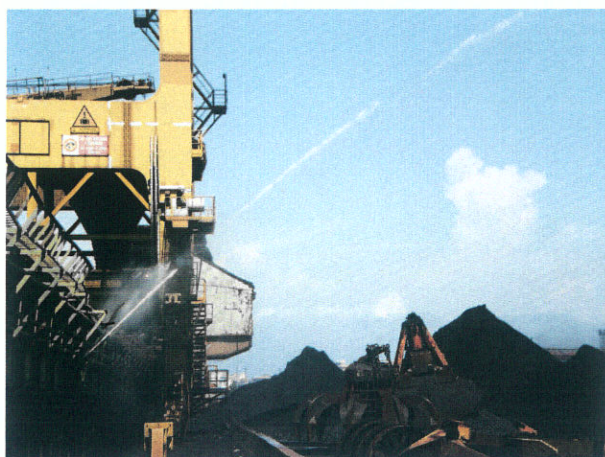
(Irroratore nastro 1, lato monte in funzione con pompa attiva)
