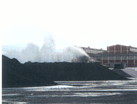
Foto 3. Alcuni irroratori dell'anello 1 (parchi minerali) in funzionamento in sequenza.
