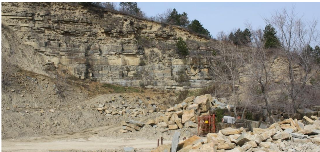
Coltivazione delle arenarie di Muggia, note come "masegno", nella Cava Ex Gorlato (Ditta Renice S.r.l., TS)
