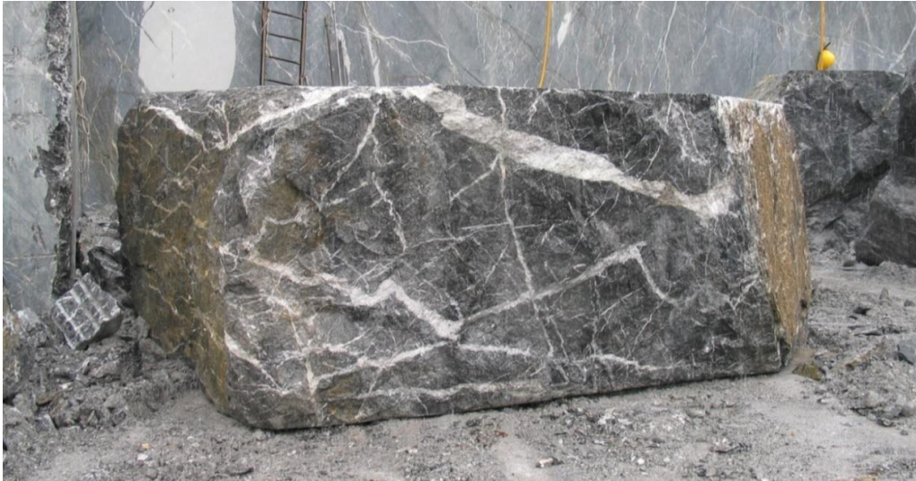
Coltivazione per bancate alte di marmo "Grigio Carnico": blocco risultante dopo il ribaltamento sul piazzale (Cava Pramasio, UD)
