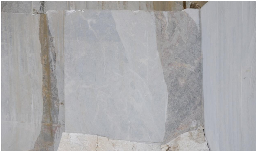
Coltivazione per gradino basso nella cava del marmo "Fior di Pesco" (Cava Avanza, UD)
